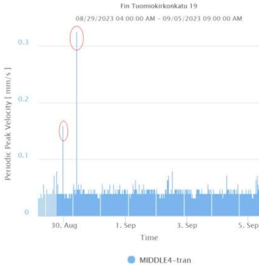
Kuva 6. Rautatien suuntaan värähtelyn heilahdusnopeuden huippuarvo. Mittaajien aiheuttamat häiriötapahtumat on ympyröity.
